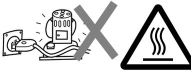
差し込みプラグを抜くときは、電源コードを引っ張らないでください。電源コードを引っ張るとコードが傷つき、火災・感電の原因となることがありますので必ず電源プラグを持って抜いてください。
