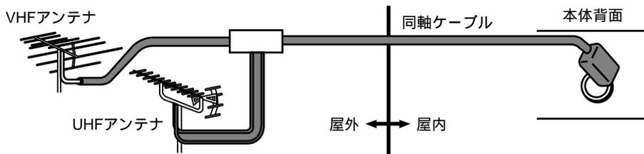
アンテナ線の種類によっては、アンテナ整合器（付属品）を取付けてください。
