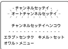
**5** 1チャンネルから順次、受信可能なチャンネルを探していきます。テレビ画面右下側にサーチ中のチャンネルを順次表示します。
