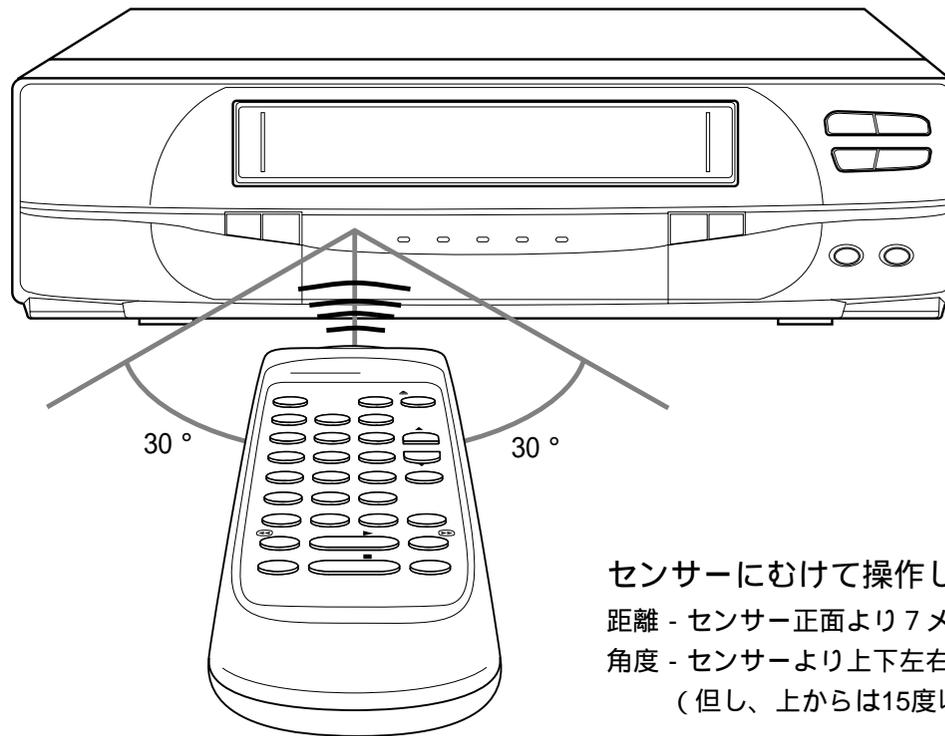
センサーにむけて操作してください。
