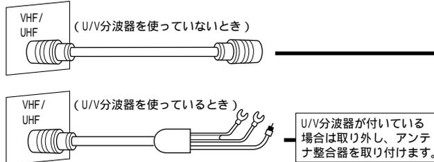
U/V分波器が付いている場合は取り外し、アンテナ整合器を取り付けます。
