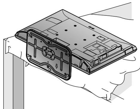
**2** ネジ穴に取り付けたスタンド取付ネジ(付属品)を取りはずします。
