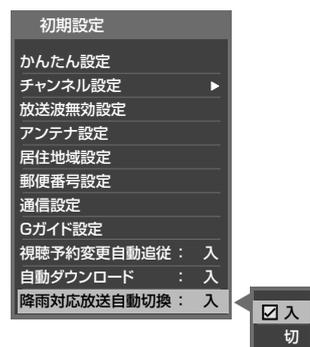
「入」… 受信状態に応じて、自動的に降雨対応放送に切り換えます。
