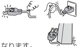
電源は、必要に応じてブレーカーやヒューズを設置した専用回路からとる
