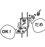
空気吸い込み口や吹き出し口をふさがないようにしてください。感電、けが、故障の原因になります。
