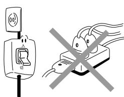
スイッチの代わりに電源プラグを抜き差しして運転、停止を行わないでください。事故、故障の原因になることがあります。
