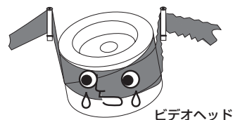
結露が発生したときのテープが巻き付いてしまった状態
