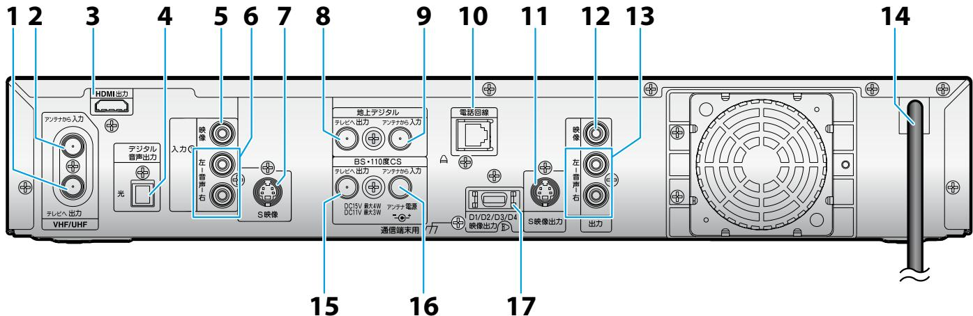
1. VHF/UHFアンテナ出力端子 (参照 31ページ)
